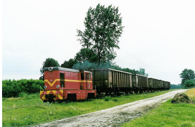
Fot. 8. Pociąg towarowy transporterowy z normalnotorowymi wagonami węglarkami między Rawą a Rogowem, 25.07.2001 r.. Fot. M. Izidorczak
