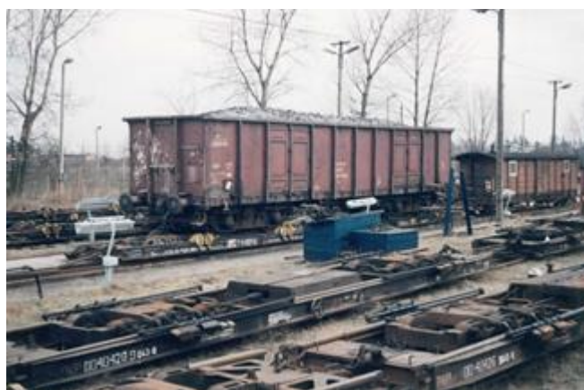
Fot. 9. Wagon normalnotorowy załadowany węglem po przetoczeniu na wąskotorowy transporter na stacji Rogów Towarowy Wąsk. 1995 r. Fot. M. Jerczyński.
