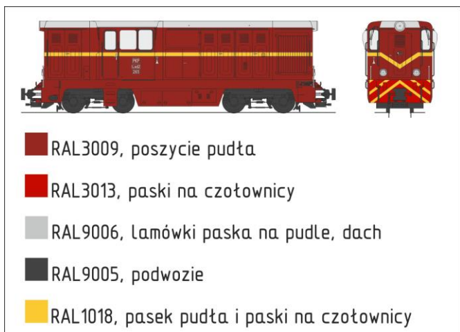
Rys. 1. Malowanie fabryczne późniejszych partii lokomotyw z przetłoczonymi drzwiami, rys. M. Wojda, A. Wawrzyniak
