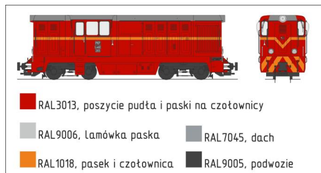
Rys. 3. Malowanie po naprawach rewizyjnych w ZNTK Nowy Sącz, rys. M. Wojda, A. Wawrzyniak
